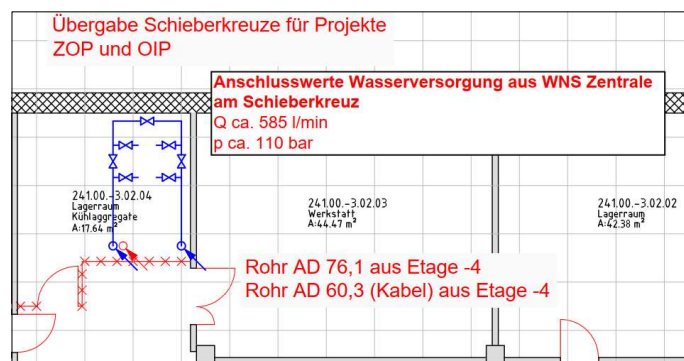
Abbildung 2 Anbindepunkt WNSA im Zwischenbauwerk
